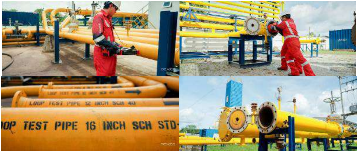
รูปสถานที่ทดสอบ (Dexon Test Yard) อุปกรณ์ที่ใช้ในการตรวจสอบท่อส่งก่อนปฏิบัติงานจริง
